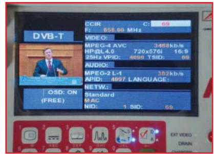
4 Εικόνα σε MPEG4 με video bitrate 10Mbps και audio bitrate στα 384Kbps. Παρατηρήσαμε ότι το chipset του encoder δεν μπορεί να συμπιέσει σε ρυθμό μεγαλύτερο των 4Mbps σε MPEG4.
