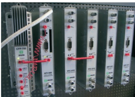
1. Το MTI ανήκει στην οικογένεια ClassA της IKUSI και χρησιμοποιεί τον ίδιο εξοπλισμό. Η μονάδα MTI είναι η δεύτερη από αριστερά.
