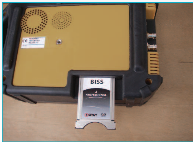
1 Με MPEG2/4 και CI το πεδιόμετρο μπορεί να προβάλλει εικόνα στην οθόνη 7".
