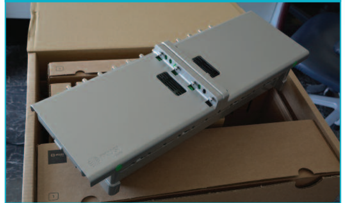
4 Το rack frame του IKUSI Flow πριν και μετά το ...ξεδίπλωμά του! Μέχρι τέλους, δεν απαιτεί κανένα εργαλείο.
