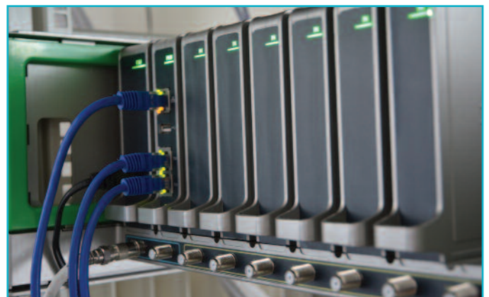
6 Οι «φέτες» του νέου Headend, κατασκευασμένες από μαγνήσιο, φιλοξενούν μονάχα το led λειτουργίας στην πρόσοψή τους.
