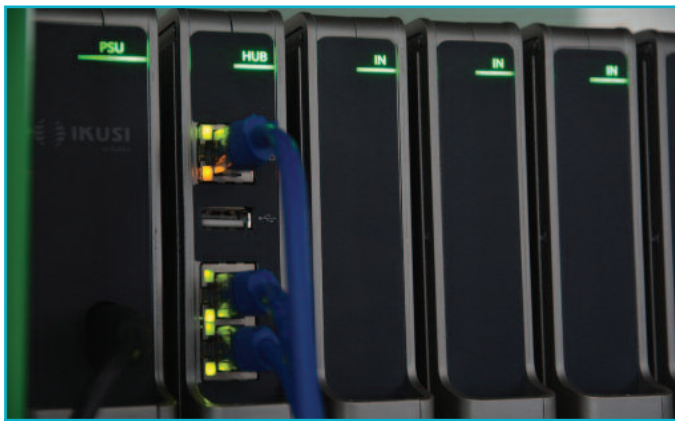
7 Απαραίτητη για τη λειτουργία του κέντρου η μονάδα διαχείρισης με μια θύρα Ethernet για προγραμματισμό και 2 θύρες Gbps για Streaming.
